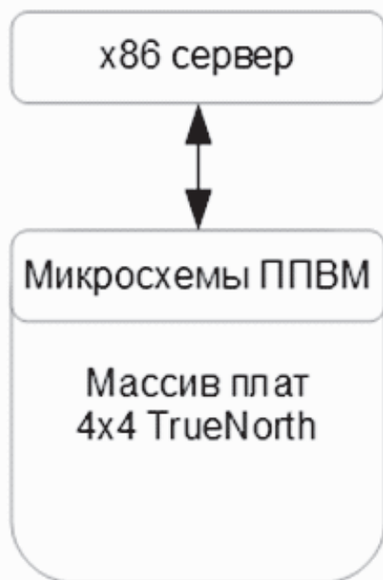
Рис. 4. Схема вычислительной системы на основе нейрокомпьютера
